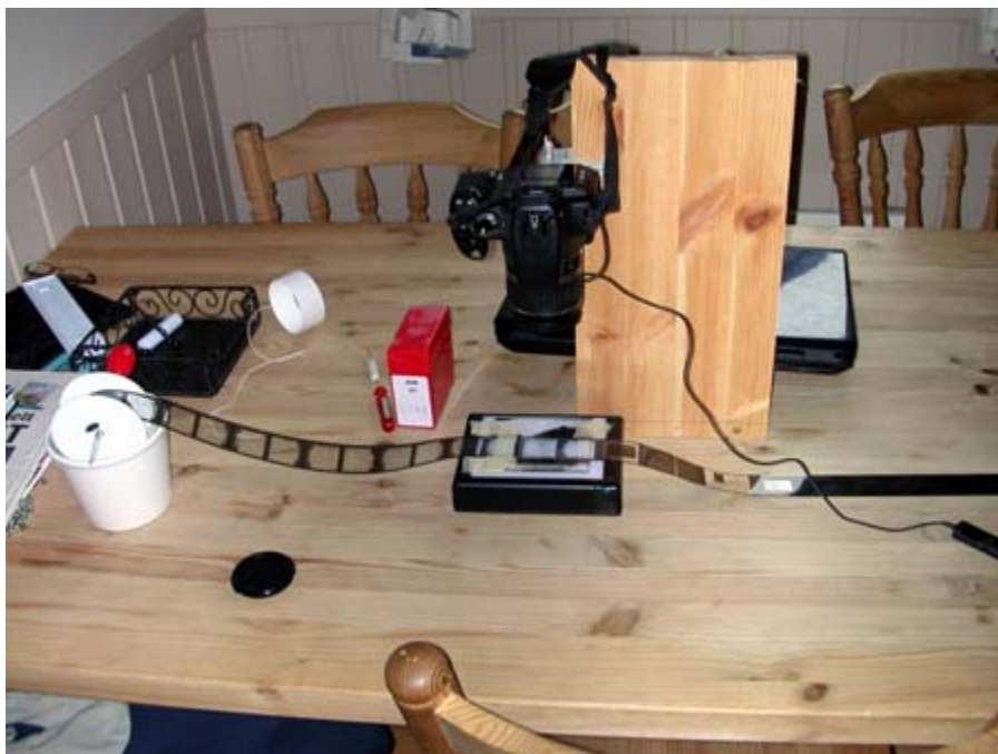
Avfotograferingsutstyr for mikrofilm. En trenger: Trefføl, skrujern, potteskjuler, lysbord, digitalkamera og fjernutløser. Her brukes en Canon EOS 350 digital speilrefleks. Foto: Bengt Stangvik
