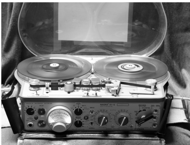
Nagra IV-S, innkjøpt i 1977, stadig i bruk til avspilling av filmlyd med låst synkronisering. Nagra er polske for «opptak». Foto: Sff 2013, Kennet Staurset Fåne
